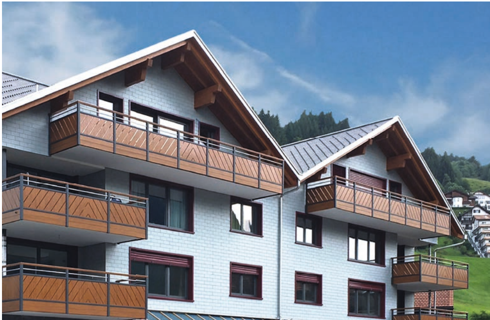
Geländer aus PVC in Holzoptik und Füllung mit diagonalen Lamellen, Abschluss mit Handlauf
